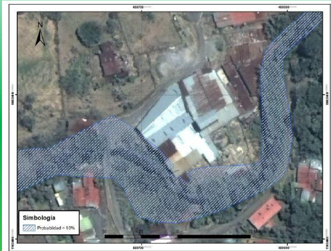
Figura No. 4.32 Mapa de inundación entre secciones 93-101, para un caudal de 10% probabilidad de ocurrencia.
