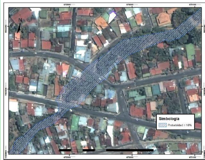
Figura No. 4.30 Mapa de inundación entre secciones 33-39, para un caudal de 10% probabilidad de ocurrencia
